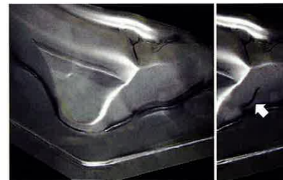
図4 金型絞り加工中に製品で発生したき裂
