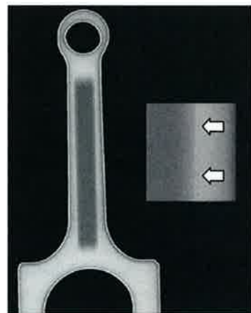
図1 コンロッド内のき裂
