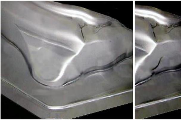
写真-1 金型絞り加工中に製品で発生した亀裂
